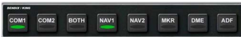
Le panneau audio active ou désactive l'émission des sons provenant des différentes radios. Dans le cas de COM1 et COM2, il contrôle aussi quelle radio COM est utilisée pour la transmission. BOTH vous permet d'entendre à la fois COM1 et COM2, mais nous ne pourrez émettre que de COM1.
