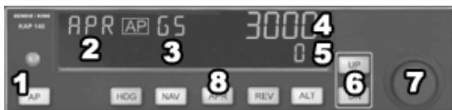
1. **Commutateur principal Pilote Automatique** (également présent sur le tableau de bord principal)
