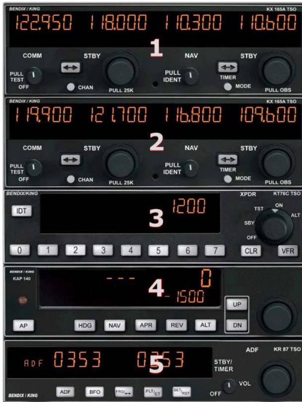
1. **radio COM1/NAV1.** Se reporter à la section *Utilisation des Radios* plus avant dans ce chapitre.
