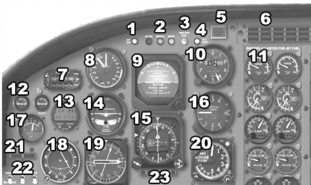
1. **Voyant pilote automatique désengagé** : allumé lorsque le pilote automatique n'est pas engagé.
